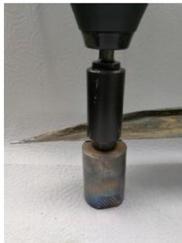
Baumstumpf, in einer Dengelbank Die Dengelfee in ein SDS+-Bohrfutter gesteckt und über die jeweilige Hülse gesteckt. Das Sensenblatt wird auf den aufgelegt und der Bohrhammer / des Sensenblatts wird vom Bart bis Dengelfee durchgeführt. Bei einer
